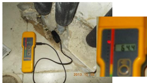
בדיקת לחות ברצפת מרפסת השרות ליד הצינורות של המערכת הסולרית
